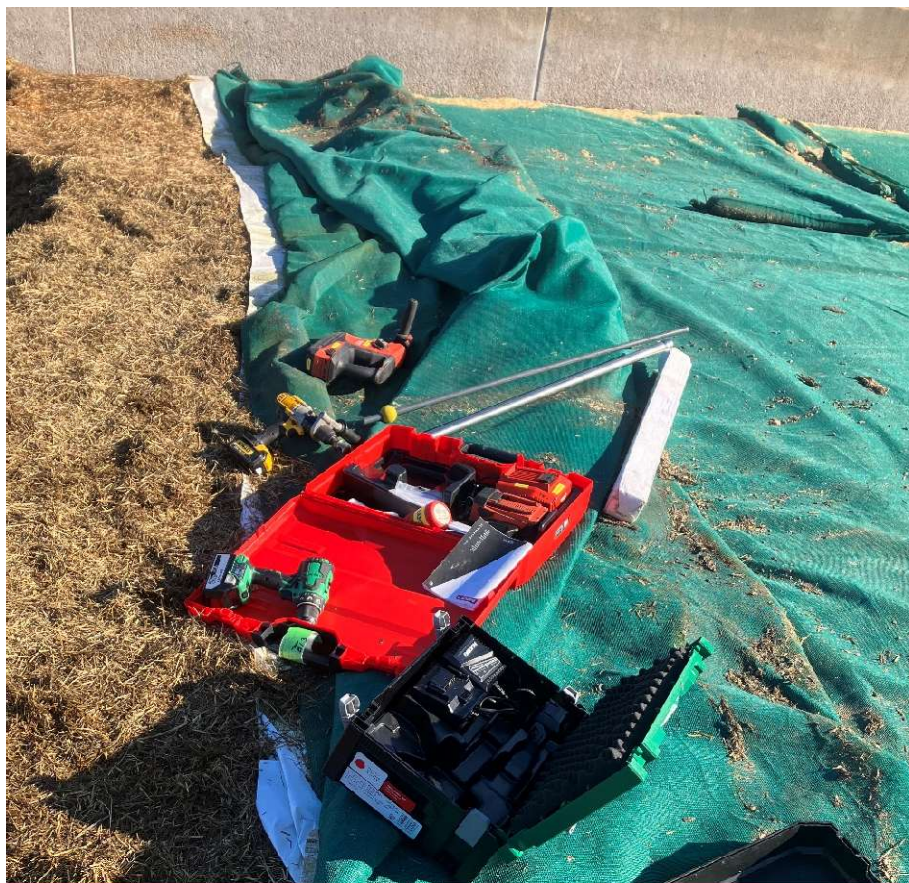
Figur 2. Några av de borrmaskiner som testades tillsammans med borr i försök att hitta en borrmaskin som orkade driva borren ända ner genom hela plansilon.
