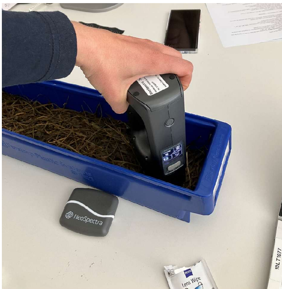
Figur 5. Scanning av ensilage med handhållna NIR-instrumentet NeoSpectra.
