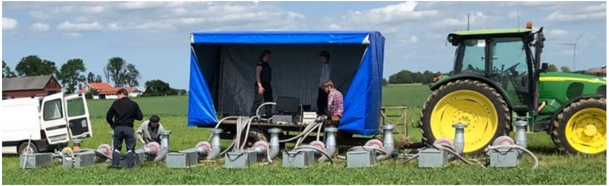
Figur 1. Vindtunnlar och utrustning för mätning av ammoniakförluster vid gödselspridning.
